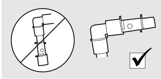
Platzieren Sie den Atemwegadapter nicht zwischen dem Endotrachealtubus und einer Tubusverlängerung, da hierdurch die Patientensekrete die Adapterfenster blockieren und zu fehlerhaftem Betrieb führen können.
