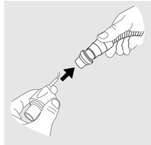
**5** Achten Sie darauf, den CO<sub>2</sub>-Sensor mit der LED nach oben zu positionieren.
